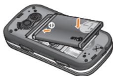
5. Para volver a colocar la tapa posterior, deslice la parte inferior hasta la posición correcta y presione los bordes hasta escuchar un clic.
