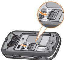
4. Para insertar la batería, alinee los contactos dorados de la batería con los conectores correspondientes en el compartimiento de la batería. Luego, presione el otro extremo de la batería hacia abajo hasta que entre en su sitio.
