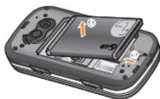
3. Deslice la tarjeta SIM en la ranura correspondiente de modo que la tarjeta quede en su sitio. Asegúrese de que el ángulo con la muesca quede en el extremo superior derecho y que los contactos dorados de la tarjeta estén orientados hacia el teléfono.
